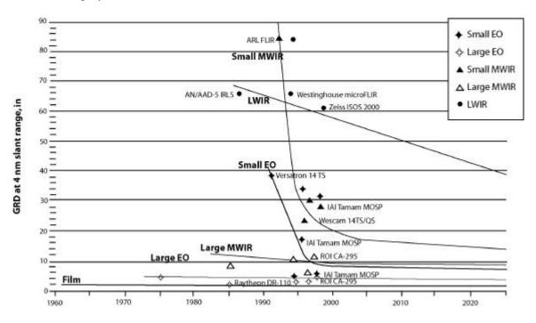
FIGURE 4.2.2-1: EO/IR SENSOR GROUND RESOLVED DISTANCE TREND.
