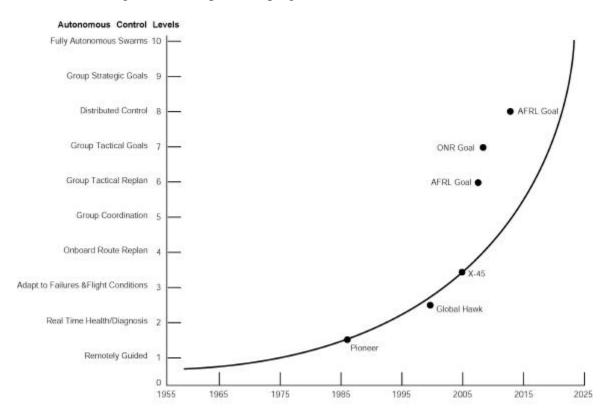
FIGURE 4.4-2: AUTONOMOUS CONTROL LEVEL TREND.
